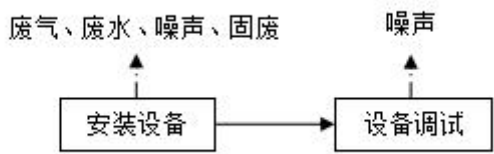
图 2-3 项目施工期工艺流程及产污环节图
